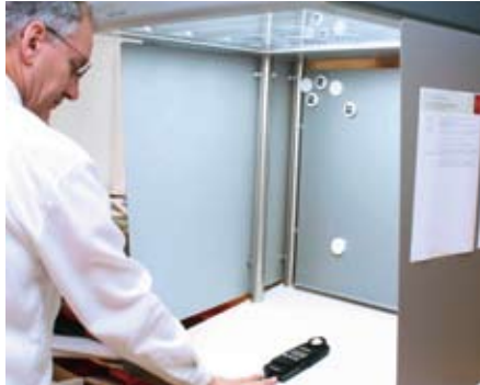
4. Standardisert betraktningsslys: Kontroll mot ISO 3664, P1 streng vurdering.
