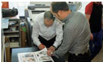
8. Testtryktrykkene merkes: Hvert 200. ark tas ut for måleteknisk analyse.
